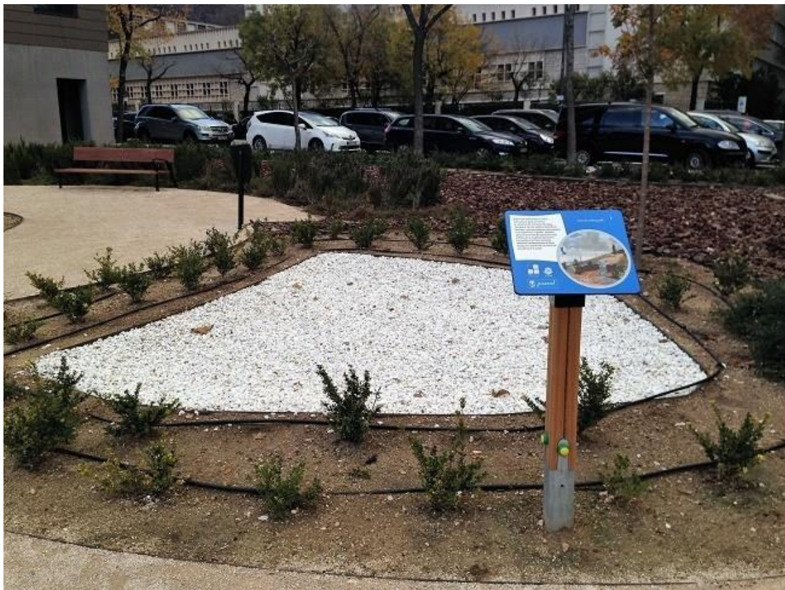
Imagen 15. 6. Pequeña área de infiltración en un parque. Fuente: Elaboración propia
